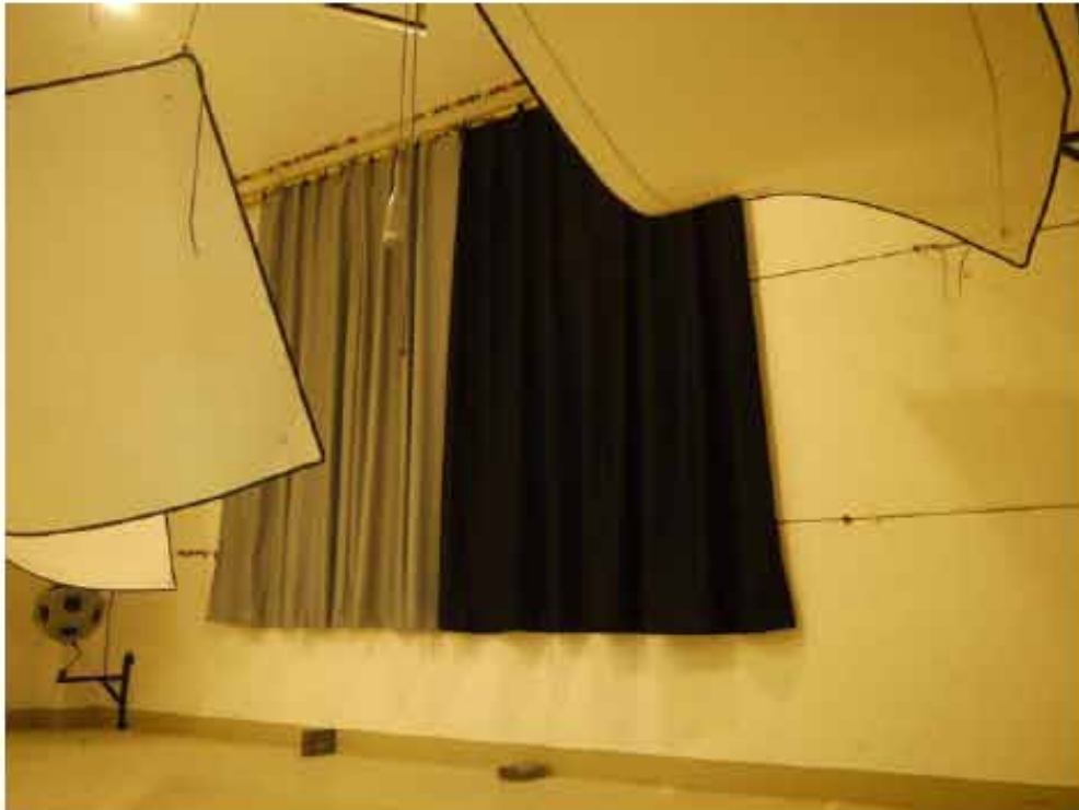
Foto B.2 Prüfaufbau im Hallraum – Vorhang mit Faltenzugabe (Aufbau 3)
